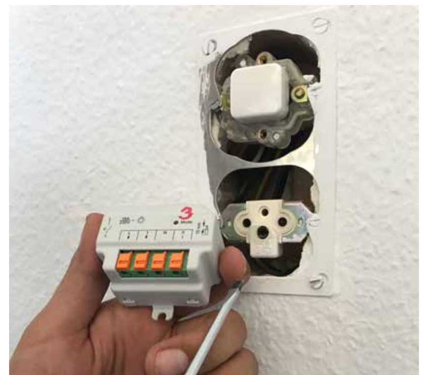
Dezentrale Schaltaktoren werden direkt in die Tasterdose installiert. Von dort aus lassen sich z. B. Licht und Storen schalten. BILD PROLIVING SYSTEMS AG
